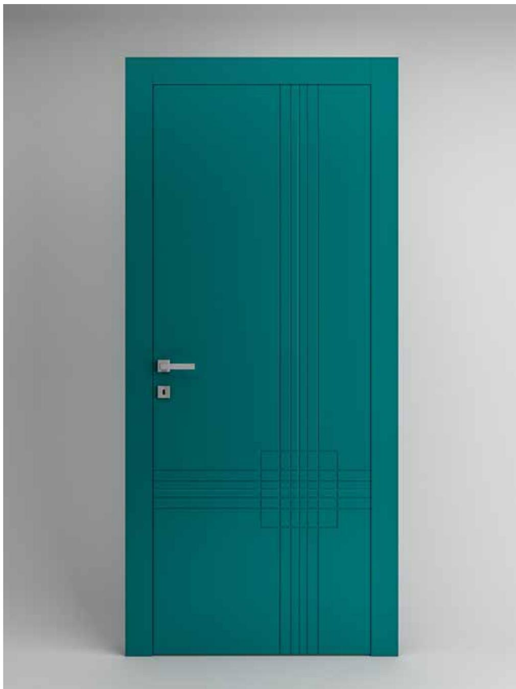
L'anta laccata pantografata ha una struttura stabile e resistente ottenuta con un telaio in legno sul quale sono applicati esternamente due pannelli separati da un riempimento interno costituito da una lastra polimerica. Questo supporto sul quale viene effettuata la lavorazione di leggera incisione è una soluzione tecnologicamente evoluta.
